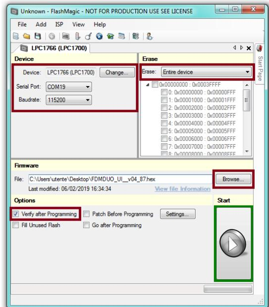
Contrôlez la communication avec le FDM-DUO en cliquant sur « ISP » et ensuite « Read Signature ». Si la communication est en place, il apparaît une nouvelle fenêtre avec certaines informations techniques.
