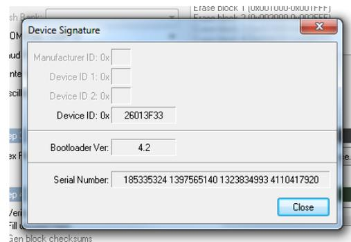
Si la communication est en place vous pouvez procéder à la programmation. Cliquez sur « Close » pour fermer la fenêtre « Device Signature » et dans la fenêtre principale du logiciel cliquez sur « Start » pour commencer la programmation.
